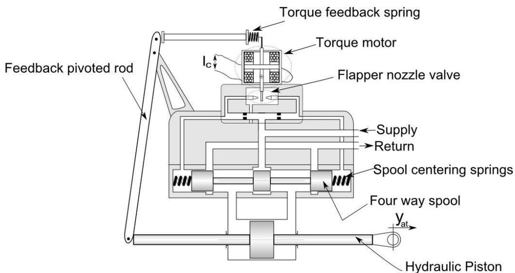
Figure 3. Servo actuator scheme.
