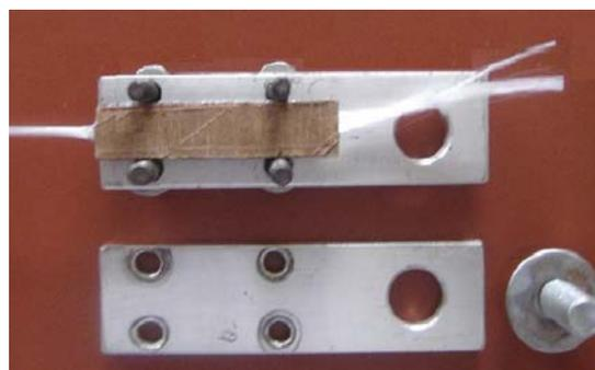
Fig. 1.b. The sandwich clamp.
