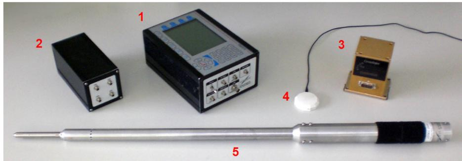
Figura 2. (1) TRM/916, (2) PotiAMP, (3) Crossbow AHRS400, (4) Antena GPS e (5) Ponta de prova anemométrica.
