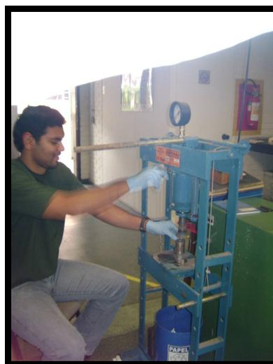
Figuras 1e 2. Moldagem e prensagem das misturas conforme NBR-5738/03.
