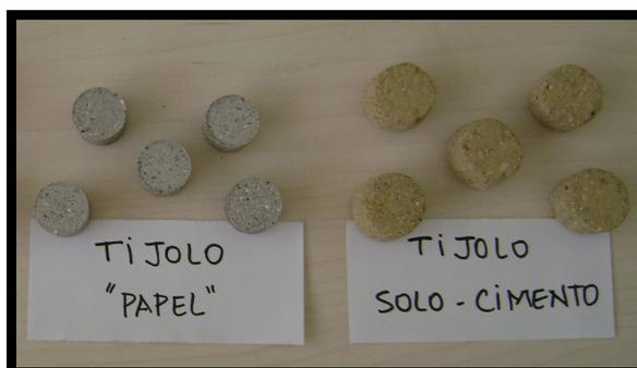
Figura 4. Corpos de prova do bloco de vedação desta pesquisa e blocos de vedação de solo-cimento.
