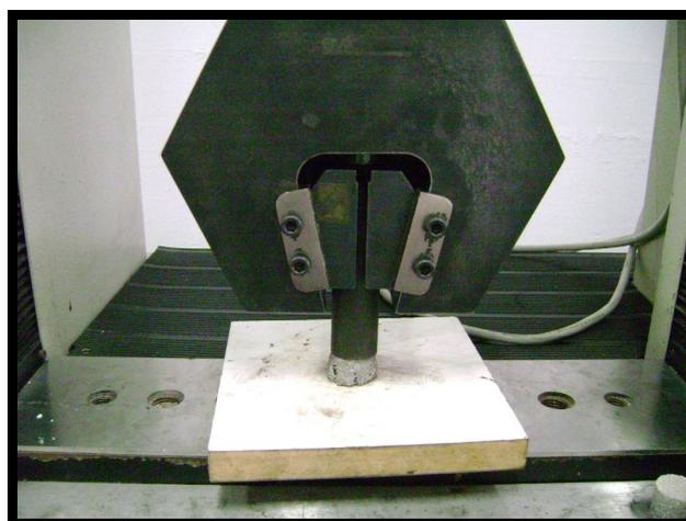
Figura 3. Ensaios de compressão simples em Mpa dos corpos de provas conforme NBR-5738/03.
