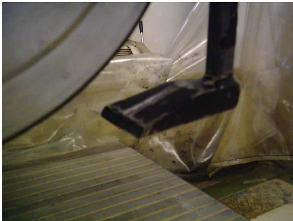
Figura 2 – Visualização da retificação através de lubri-refrigeração com bocal convencional.
