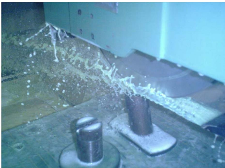
Figura 4 – Operação de perfilamento do rebolo.
