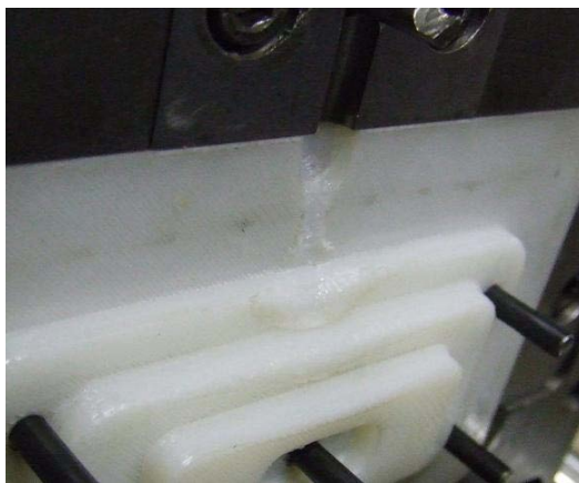
Figura 9. Inserto macho após o 15º ciclo de injeção.
