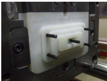
Figura 7. Inserto macho instalado no porta-molde.
