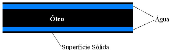
**Figura 8 - Modelo representativo do método core-flow. Fonte: Silva (2003).**
