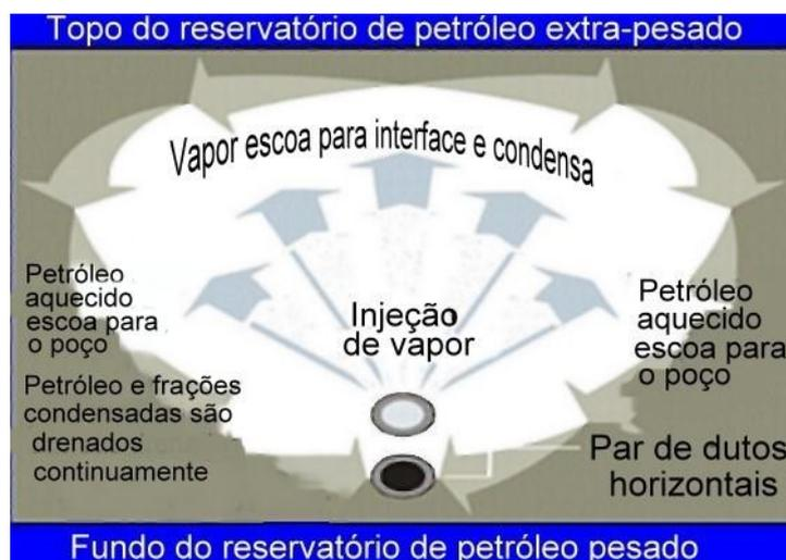
Figura 2 - Representação do Fluxo no Injetor. Fonte: Heavy Oil Info (2008)
