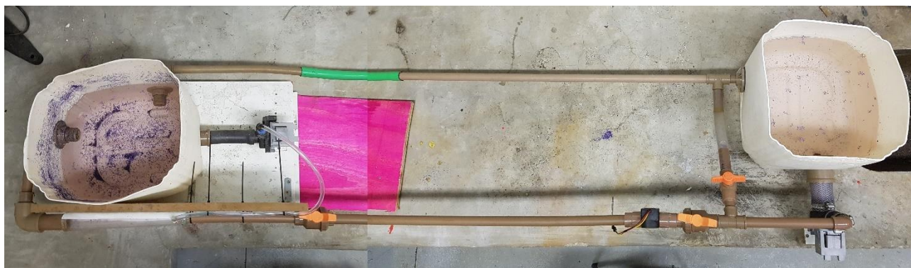
Figura 4. – Bancada para visualização de escoamento turbulento vista superior
