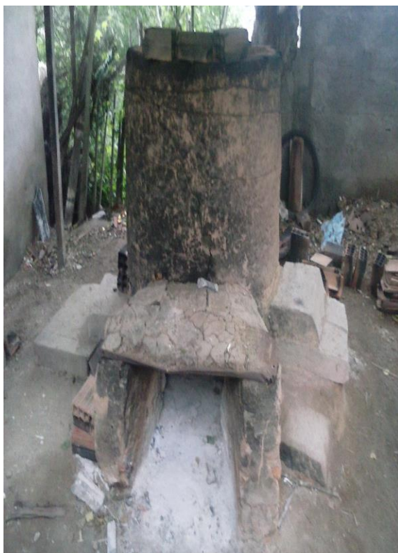
Figura 1- a) Forno do tipo cilíndrico com abertura na parte superior e “caixa” frontal b) Vista lateral, frontal e superior
