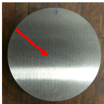
Figura 4. Amostra com processo de retificação com fluido e avarias
