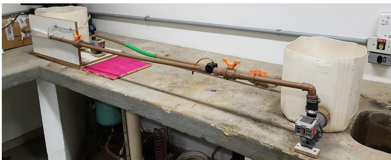
Figura 5. – Bancada para visualização de escoamento turbulento vista isométrica
